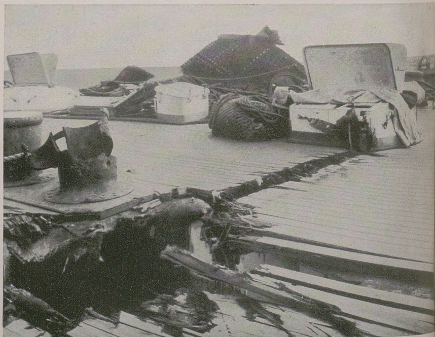
Nach der Skagerrakschlacht. Brücken- und Decktreffer auf dem Schlachtkreuzer „Derfflinger“
