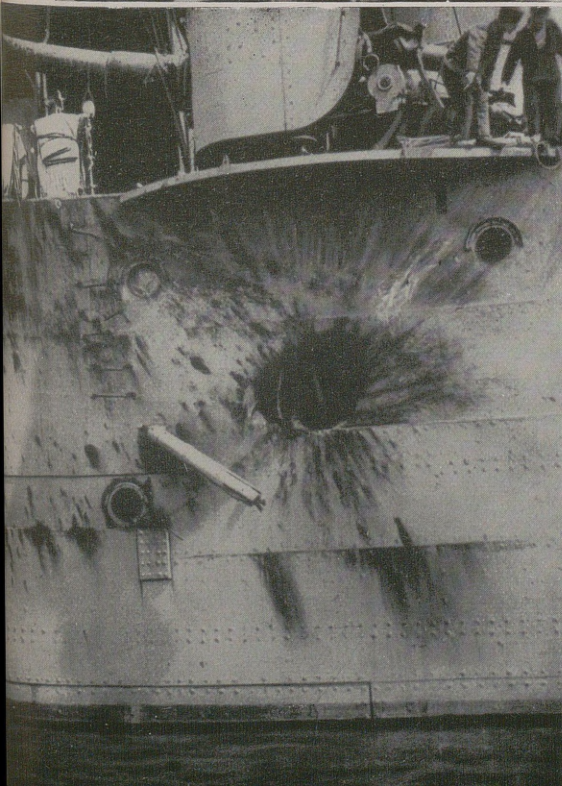
Torpedoboot „V 1“ Zerstörung des Vorschiffs durch eine Torpedoexplosion. Das Boot erreichte trotzdem den Hafen
