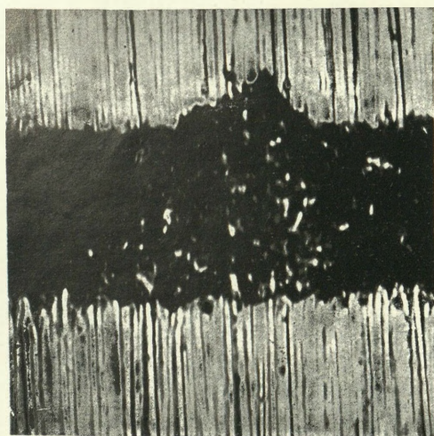
B. Ciemna wstęga jest znacznie powiększona rysa, wykonana za pomocą cienkiej igły na kawałku metalu zwierciadłowego.
