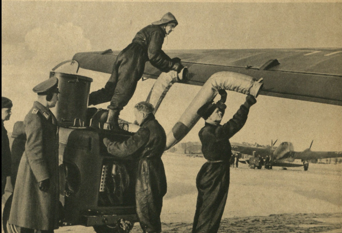
Enteisung eines Flugzeugs durch Heißluft
