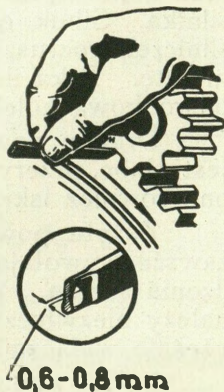
Rys. 259. Sprawdzenie gry bocznej między zębami kół rozrusznika i silnika czołga.
