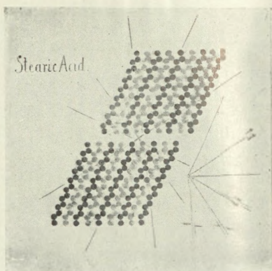
B. Ugrupowanie cząsteczek w kryształach kwasu stearynowego. Każdy zygawkowaty łańcuch przedstawia atomy węgla w jednej cząsteczce kwasu. Wzajemna odległość środków sąsiednich atomów C wynosi 1,54 angströma, podobnie jak w djamencie. Modele A i B są wykonane w różnej skali. (Grupy końcowe oraz atomy wodoru nie są zaznaczone). Ze schematu podanego przez A. Mullera z Davy Faraday Laboratory (str. 279).
