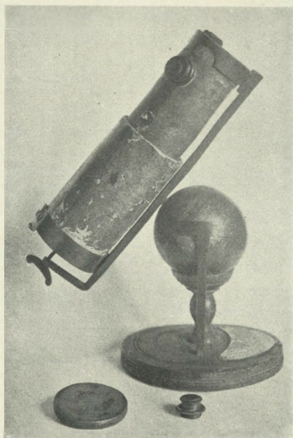
A. Stary napis na podstawie głosi: „Pierwszy teleskop odbiciowy wynaleziony przez Sir Isaaka Newtona i wykonany przezeń własnoręcznie w r. 1671”. Wysokość przyrządu około 45 cm. Za pozwoleniem Royal Society (str. 121).
