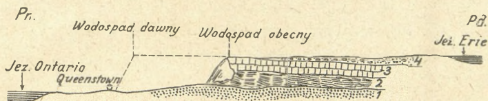
Ryc. 162. Przekrój przez wodospad Niagara: 1. piaskowce, 2. miękkie łupki, 3. twarde wapnienie, 4. osady rzek.
