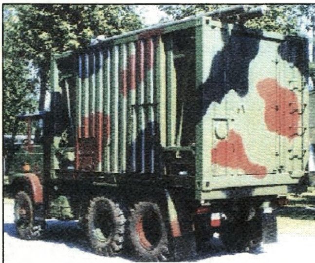
Rys. 1 Samochód STAR 266 z samowyladowczym kontenerem i pomalowanym nadwoziem (maskowanie deformujące)
