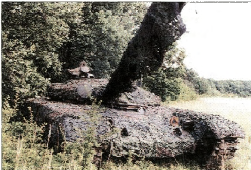
Rys. 6. Zestaw do kompleksowego maskowania czołgów ZMK-Cz zamontowany na czołgu T-72
