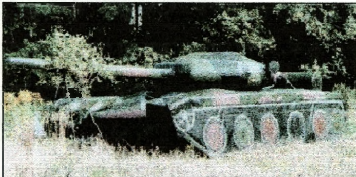
Rys. 4. Makieta pneumatyczna czołgu T-72
