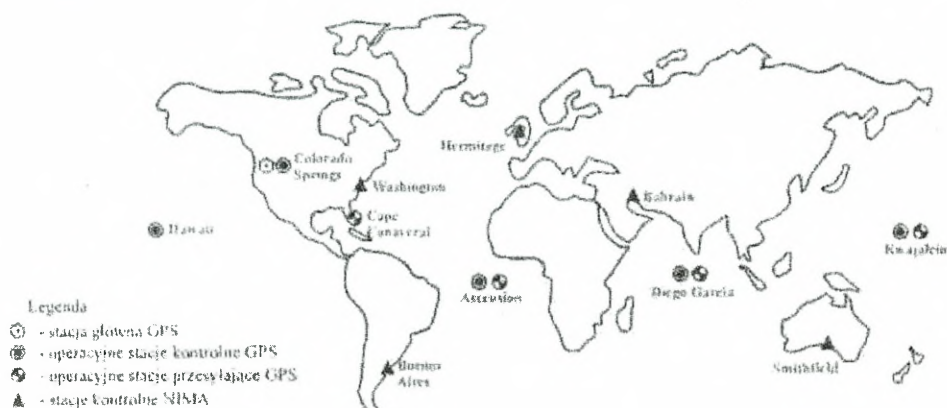
Rys. 123. Rozmieszczenie stacji śledzących segmentu kontrolnego GPS.
