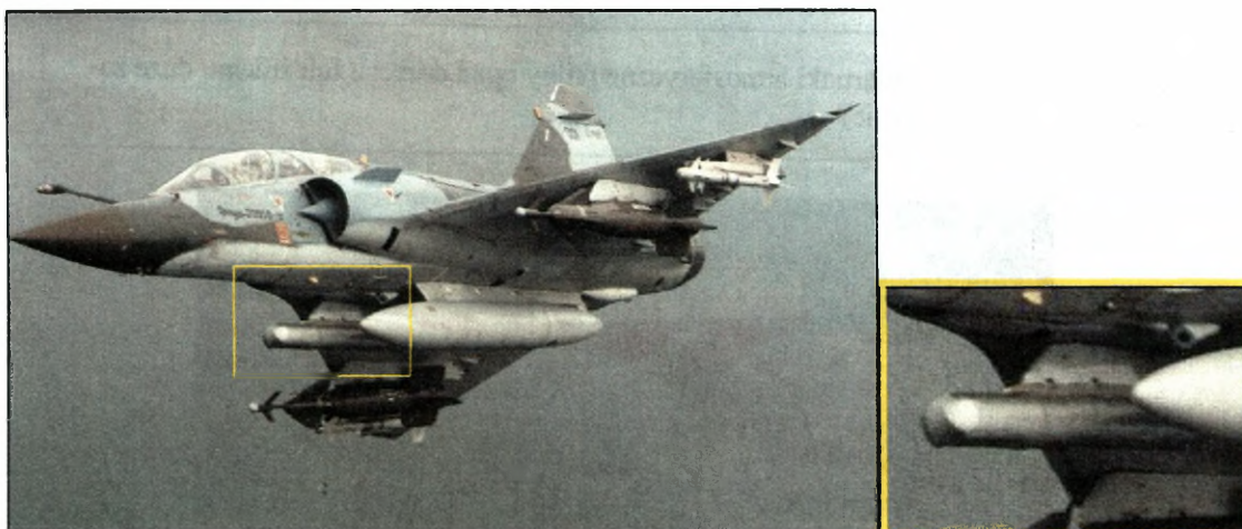
Zasobnik celowniczy CLDP z głowicą termowizyjną w jednym z wariantów uzbrojenia samolotu MIRAGE –2000 ((Źródło: Internet www.fas.org )
