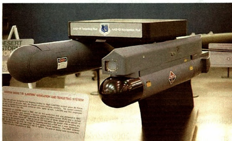
Zestaw nawigacyjno-celowniczy LANTIRN: zasobnik celowniczy AAQ-14 z lewej i nawigacyjny AAQ-13 z prawej strony (Źródło: Internet www.fas.org )
