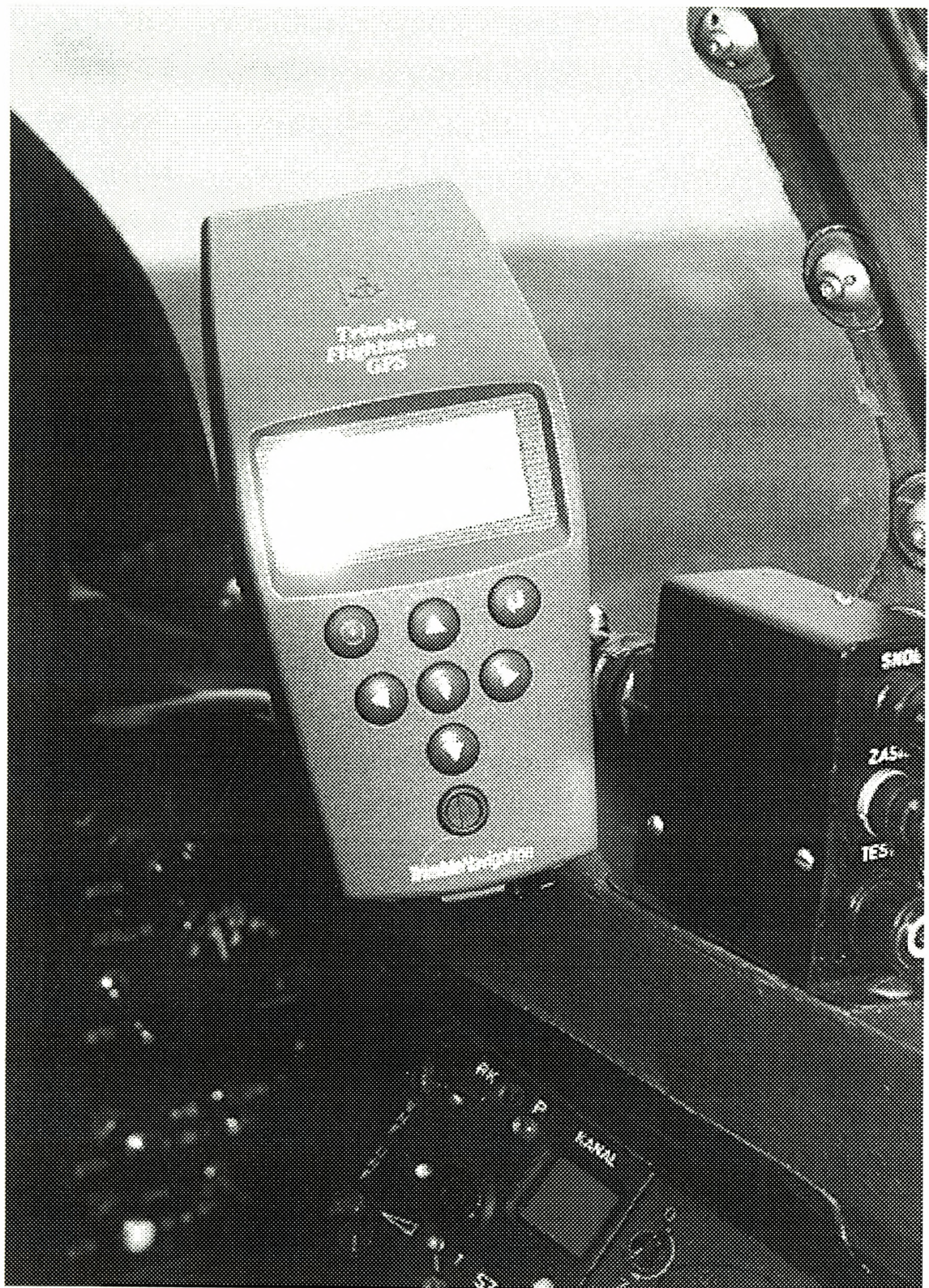
Rys. 1.5. Widok ogólny odbiornika Trimble Flightmate GPS w pierwszej kabynie samolotu TS-11 „Iskra”
