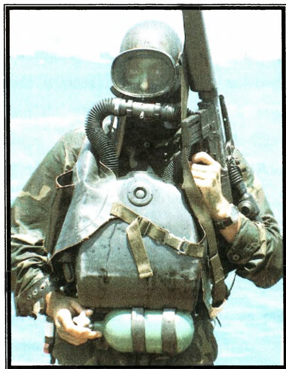
Rys. 5.20. Płetwonurek bojowy z aparatem nurkowym Dreager LARV Źródło: Micheletti, SEALs –The US Navy Commandos, Historie & Collections 1997, s. 123.
