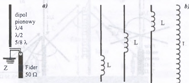
Rys. 2.9. Różne dipole pionowe jako: a) antena standardowa, b) skrócone indukcyjnościami Źródło: P. Daniluk, Anteny..., op. cit., s. 39
