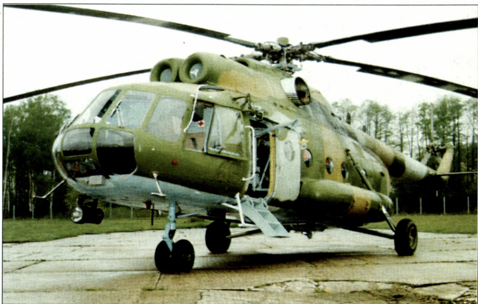
Śmigłowiec Mi-8RL, z widoczną wysuniętą wciągarką
