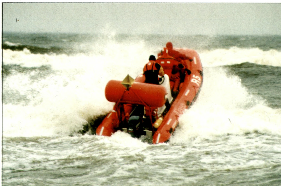
Hybrydowa łódź ratownicza typu R-5 (wyposażenie brzegowych stacji ratowniczych)
