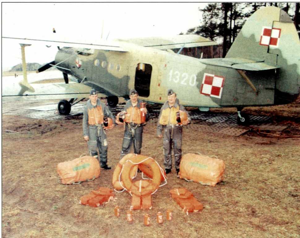
Samolot patrolowo-ratowniczy AN-2R wyposażony w system nawigacji satelitarnej GPS oraz pełny zestaw środków ratowniczych do lotów nad morzem
