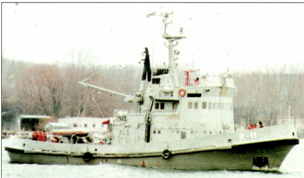
Kuter ratowniczy projektu R-30 GNIEMKO (na pokładzie widoczne elementy wyposażenia ratowniczego)
