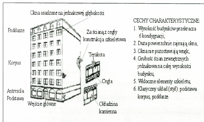
Budynek o ciężkiej konstrukcji szkieletowej - przykład
