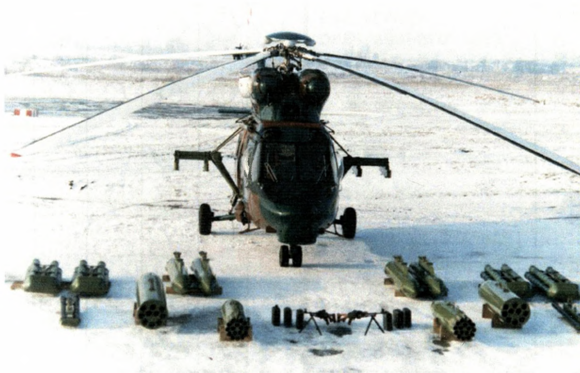
Rys. 3.7. Warianty uzbrojenia śmigłowca W-3W/WA „Sokół”.
