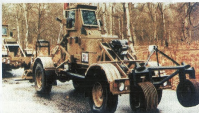
Rys. 4. Pojazd MEERKAT z trałem koleinowym w barwach IFOR
