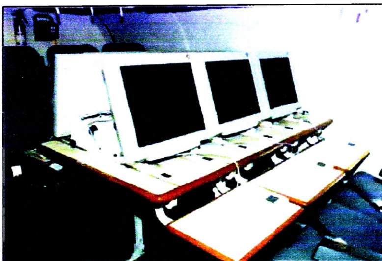
Zdj. 4. Zmodernizowane stanowiska operatorów zespołu dowodzenia samolotu E-8C systemu Joint STARS
