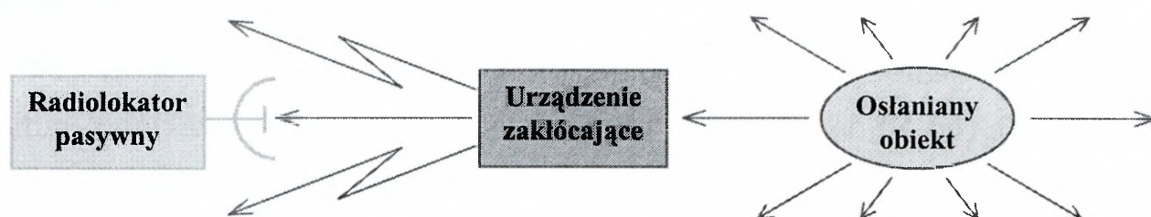
Rys. 2.21. Idea zakłócania radiolokacji pasywnej
