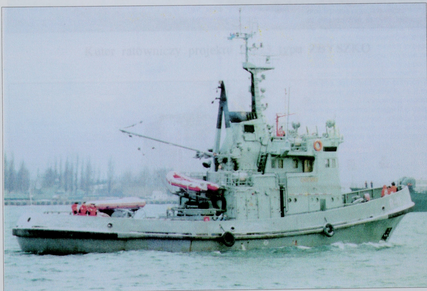
Kuter ratowniczy projektu R-30 typu GNIEWKO, na pokładzie widoczne elementy wyposażenia ratowniczego
