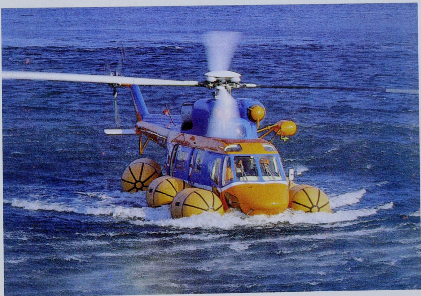
Pierwszy prototyp Anakondy podczas prowadzenia prób wodowania
