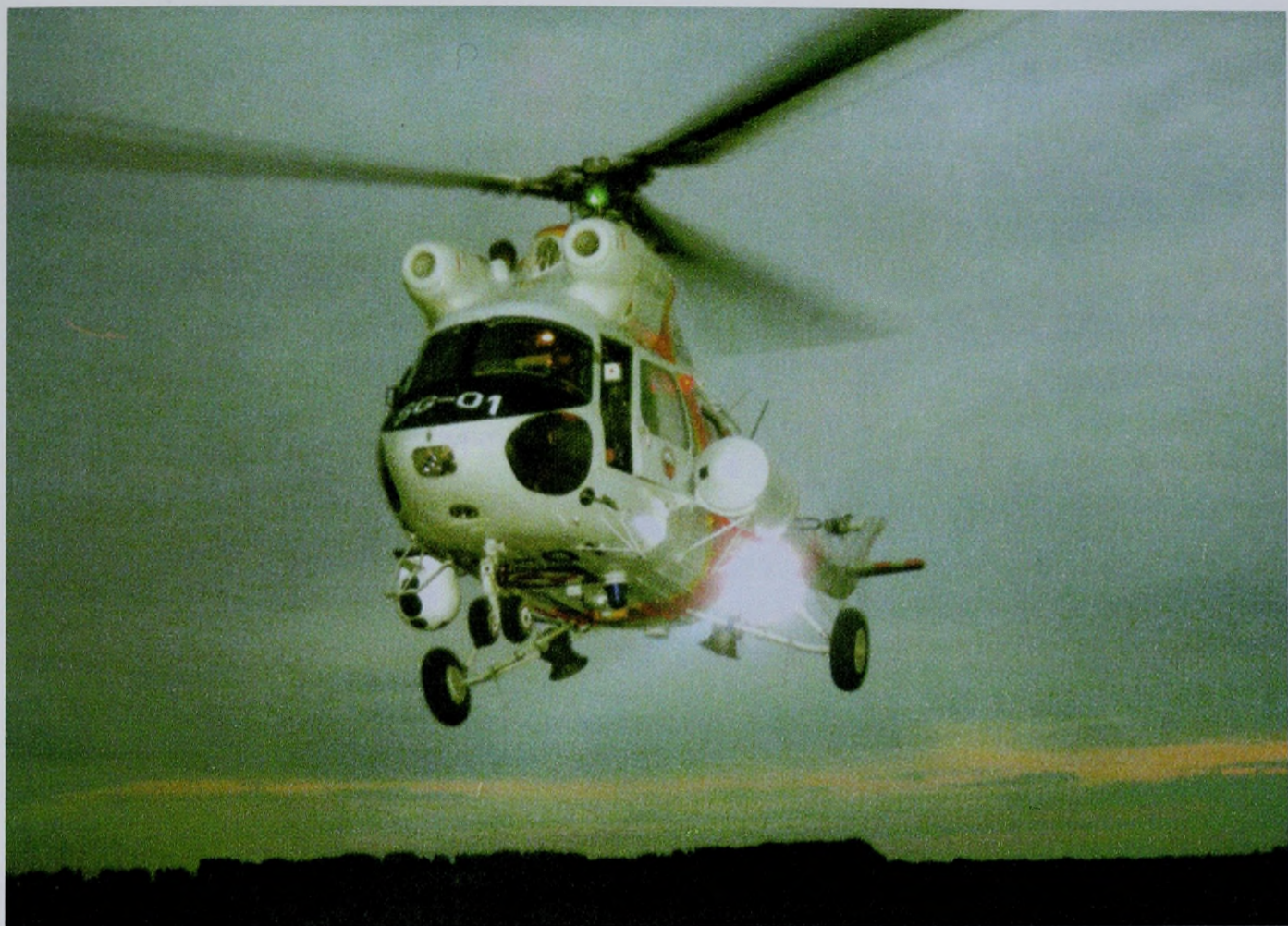
Śmigłowiec PZL Kania Straży Granicznej wyposażony w reflektory oraz głowice FLIR do obserwacji w podczerwieni
