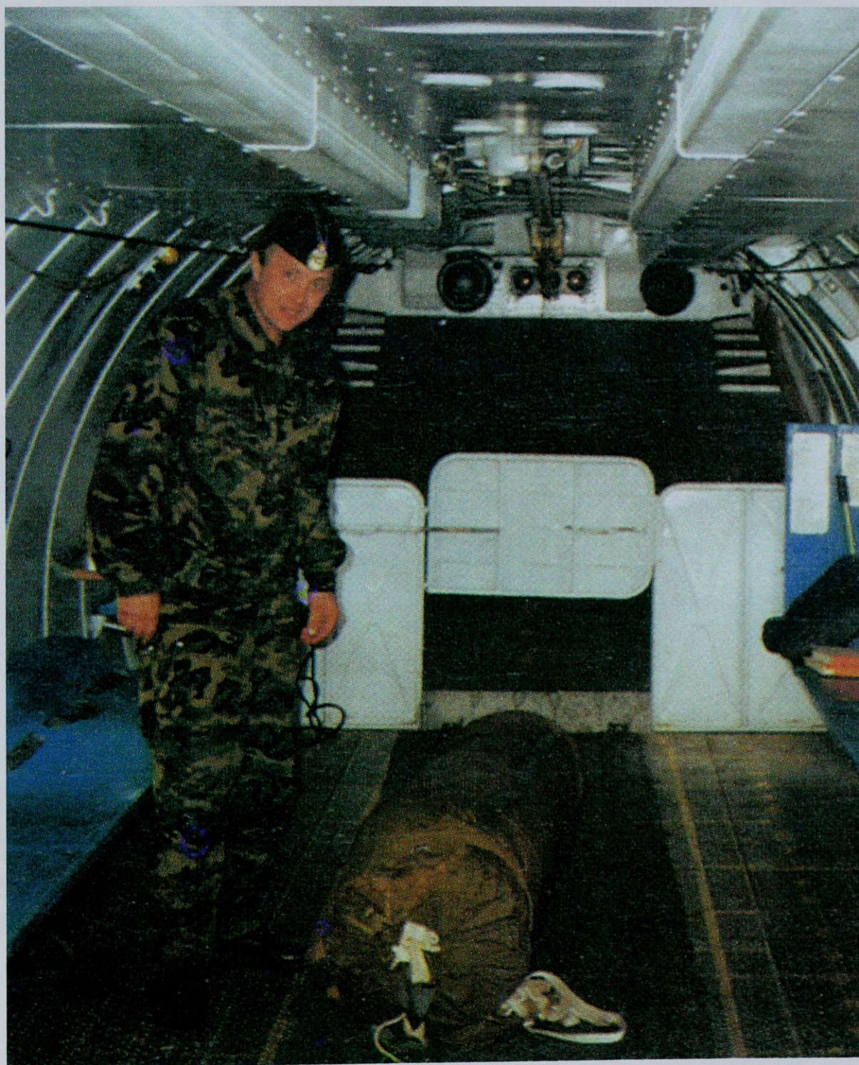
Samolot An-26 pełniący dyżury w systemie ratownictwa morskiego Rosji, oraz jego wyposażenie. Na pierwszym planie zasobnik -łódź PDMM-47
