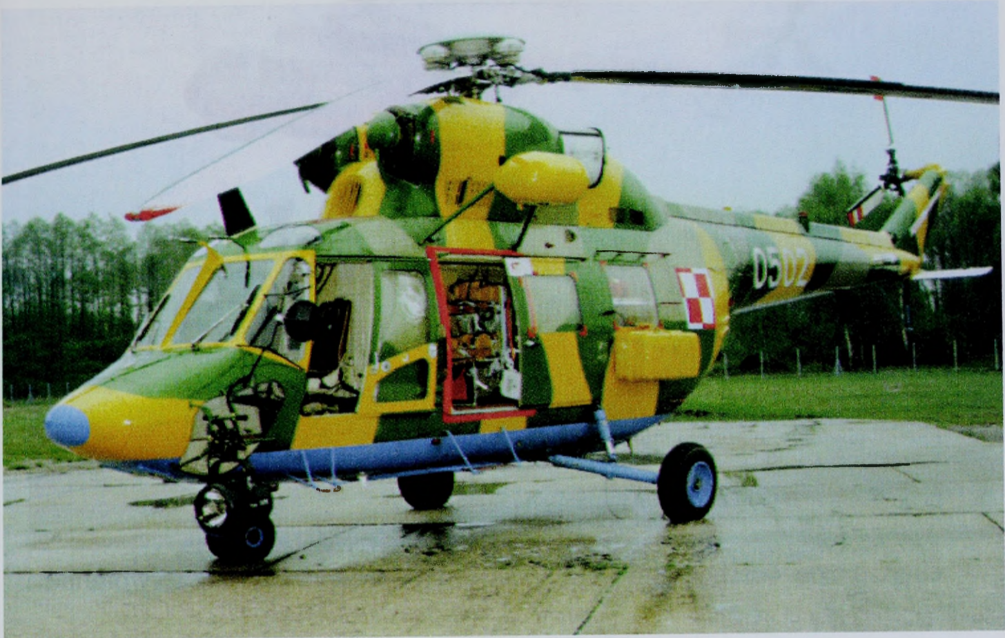
Śmigłowiec poszukiwawczo - ratowniczy W-3RL, na pierwszym planie widoczna wciągarka
