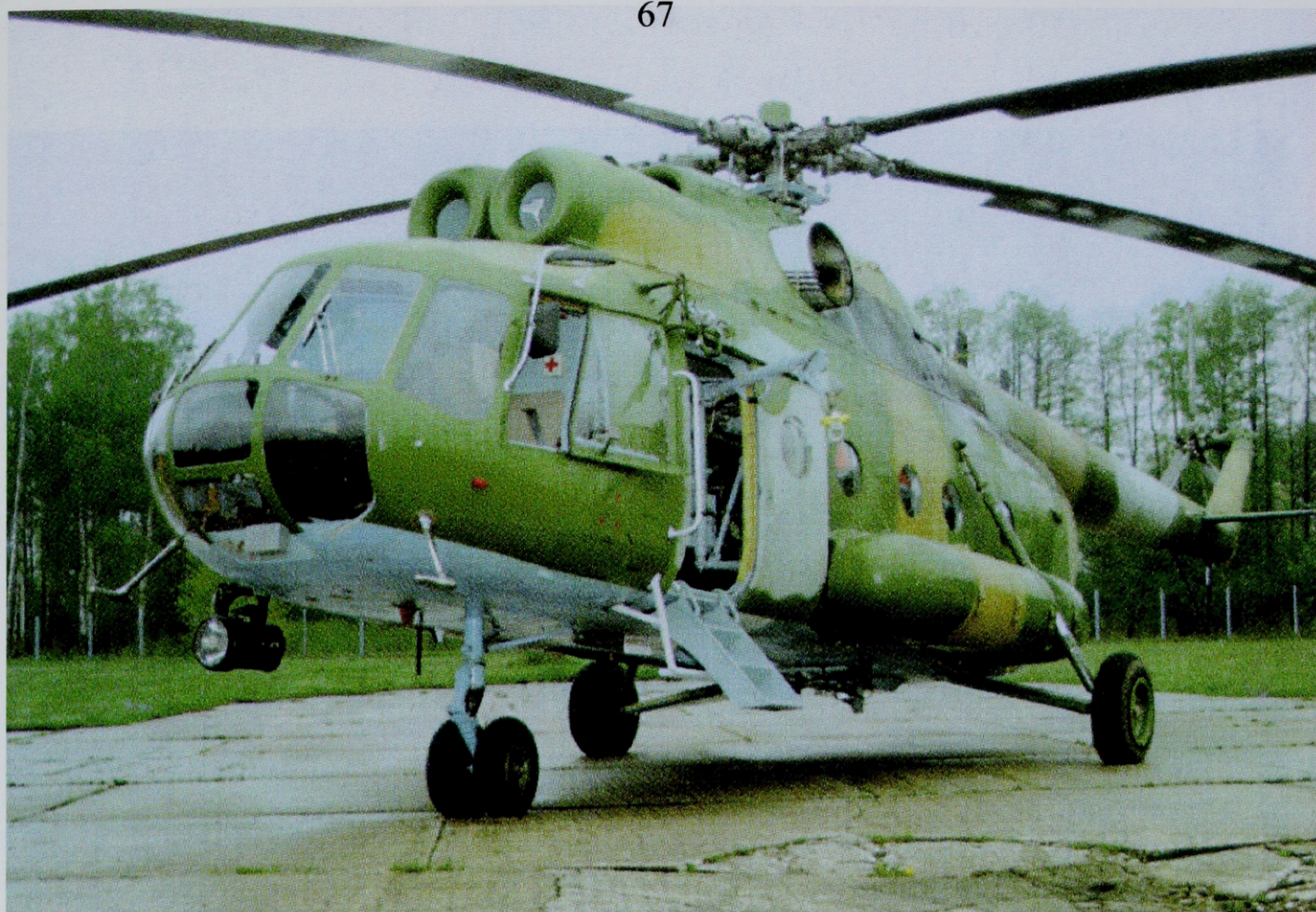
Śmigłowiec Mi-8RL, z widoczną wysuniętą wciągarką
