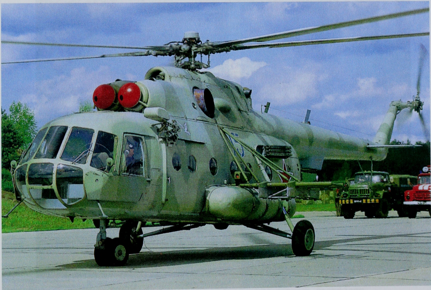
Śmigłowiec Mi-17 przed startem , nad drzwiami widoczna wciągarka
