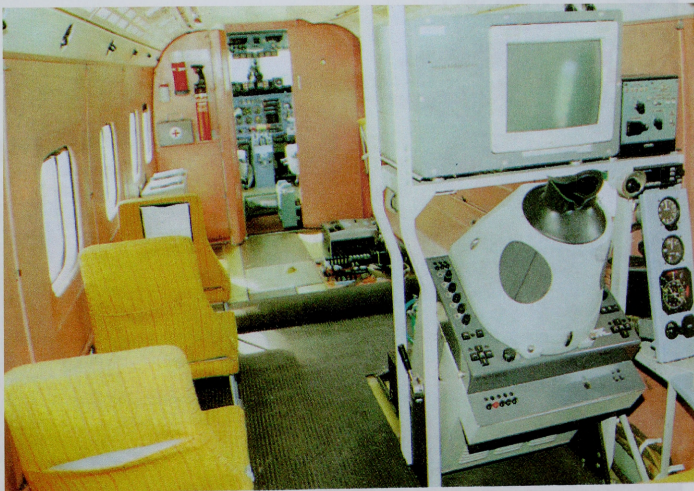
Wyposażenie poszukiwawczo - ratownicze samolotu An-28 RM „Bryza”
