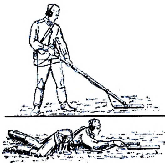
Rys. 7. Sposób rozpoznania terenu na zaminowanie za pomocą przenośnego indukcyjnego wykrywaczy min „ИМП”
