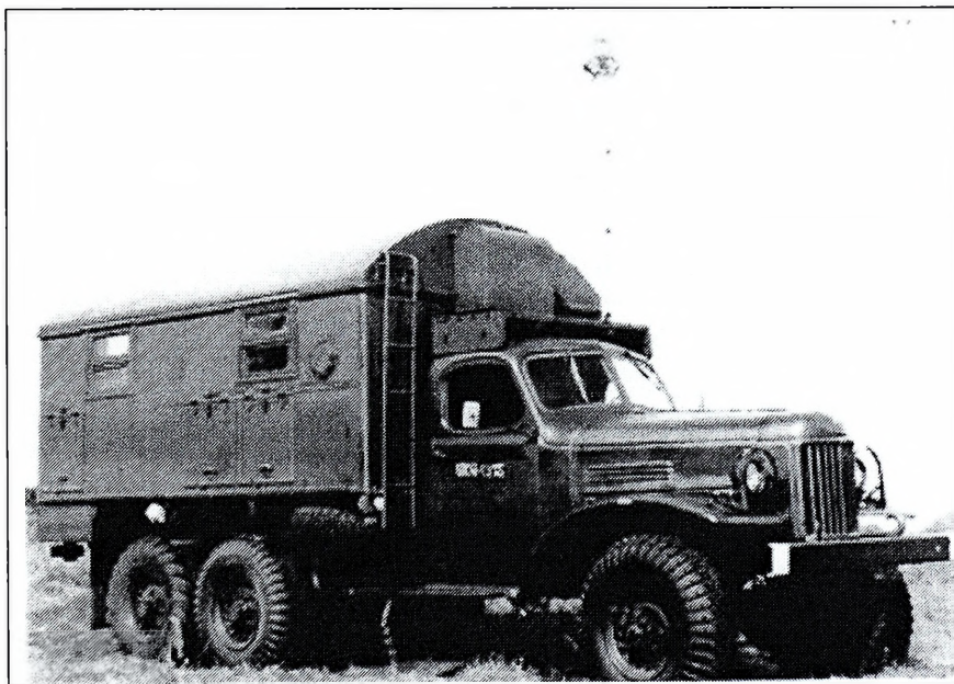
Stacja zakłóceń R-834p
