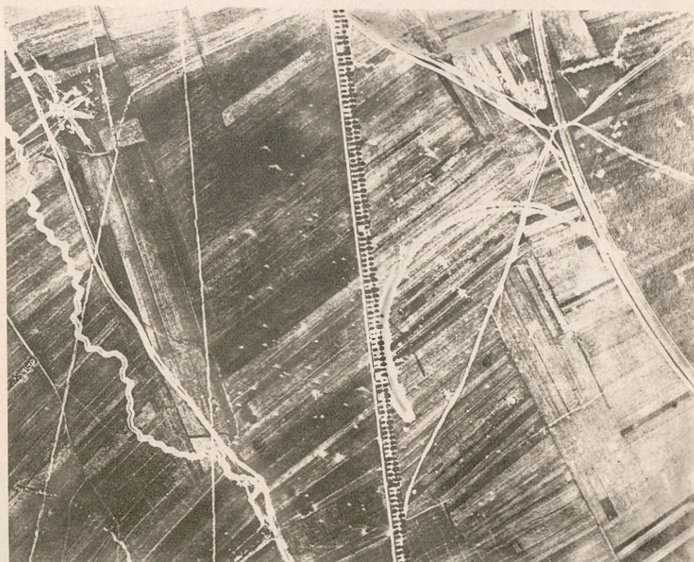
Fot. Nr. 298. Łuk toru dla dział, strzelającego z platformy kolejowej. W lewej górnej części centrala telef. opt., obok dwa rowy na kabel telefoniczny. Wys. 5000 m., F=50.
