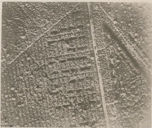
Fot. Nr. 74. Baraki ukryte w lesie. Maskowanie bezskuteczne, z powodu zachowania regularności wycięc. 34 baraki — prawdopodobnie skład amunicji. (W—1500 F=50. Zred. 1:2)
