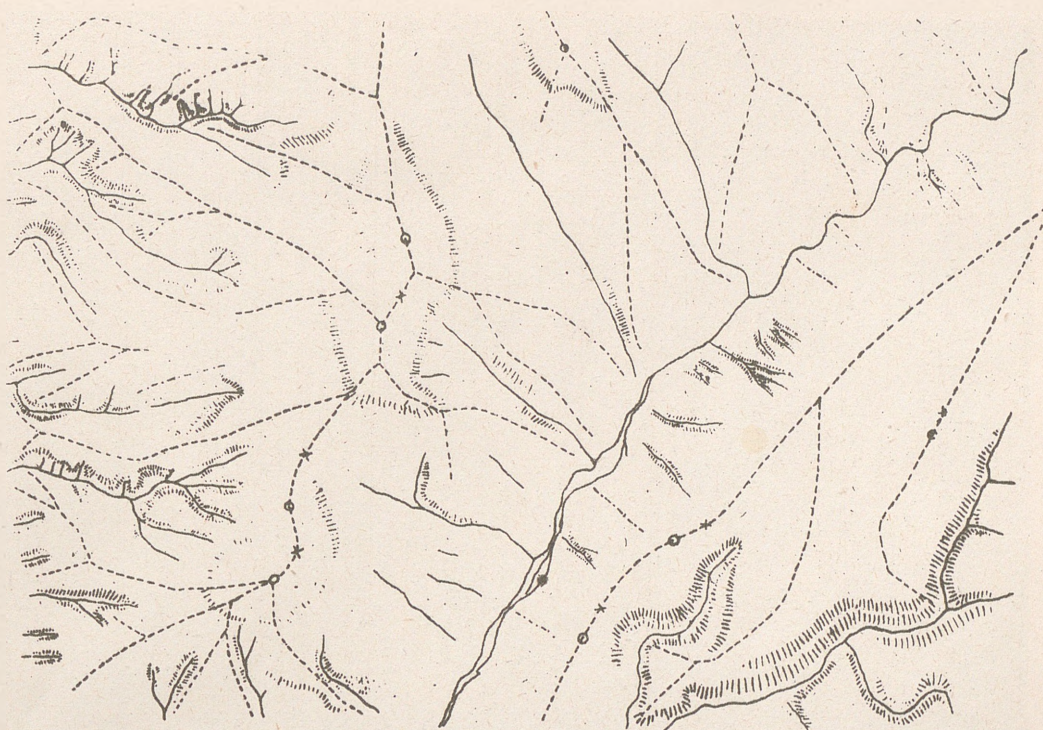
Rys. Nr. 99-a. Siatka zasadnicza z fot.99- Linja ciągła podaje siatkę hydrograficzną, — — — linję wodorozdziału, — . — . — linję zmiany pochyłości, o wzniesienia, x siodła. Kreskowaniem oznaczono silne spadki.
