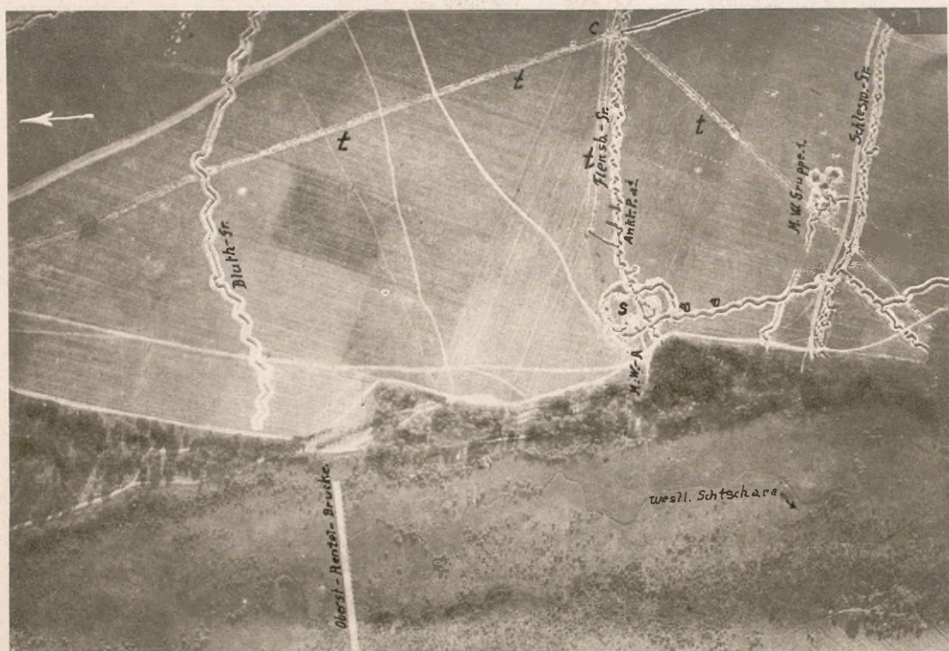
Fot. Nr. 256. Tyły stanowisk ros. nad Szczara. Centrala telefon. (c), rowy telefoniczne (t), schrony o dwu wejściach (s), M W—miotacze min. U dołu most na błocie Wys. 2100 m. F=50
