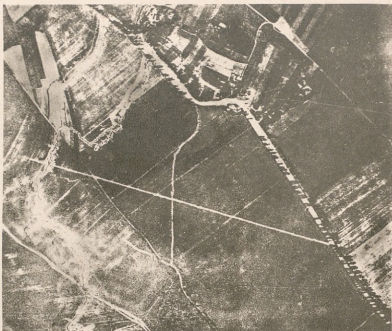
Fot. Nr. 225. Okopy austr. w rejonie Brodów. Przed okopami 3 pasy przeszkód z drutu kolczastego elektryzowanych (wiadomości 1 linii) (1) pasy przeszkód, (2) rów z kablem elektryzującym, (3) przejścia w drutach.
