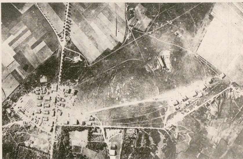
Fot. Nr. 4. Lotnisko z wys. 4000 m. aparatem F. 50. Teren: pastwisko na terenie o podłożu kredowym, 9 hangarów 30 x 35, 9 hangarów 18 x 20. ślady po 2 hangarach rozebranych, 15 baraków 12 x 30, około 20 baraków dla personelu, widocznych 46 plat. obserwac. i myśl., kolejka wąskotorowa; w dolnej części park lotniczy. (Zred. do 1/2).
