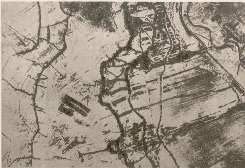
Fot. Nr. 242. Wygląd okopów zimą w czasie odwilży. Kontury okopów są niewyraźne, natomiast ruch w okopach i schrony silnie się zaznaczają. W górnej części 2 leje po wybuchach min. Wys. 2000 m., F=21, odczytane przy pomocy leńców.
