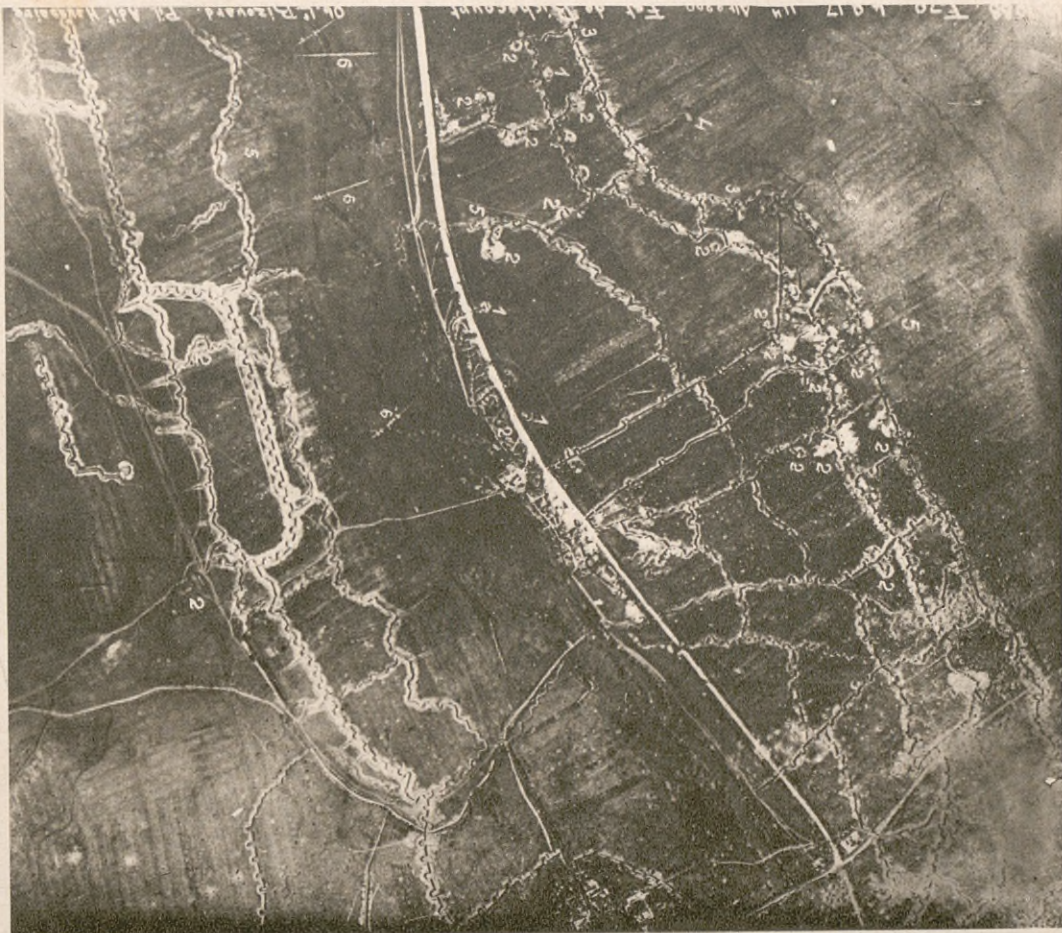
Fot. Nr. 211. Stan pod Richecourt. Wys. 2800 m., F=70. Stan. miotaczy min (1), schrony (2), stanowiska C. K. M. (3), wysunięte czujki (4), druty kolczaste (5), kładki przez rzeczkę (6).
