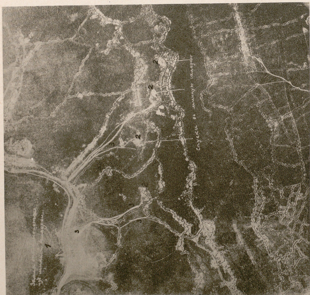
Fot. Nr. 252. Prace minierskie. Wyrzucona ziemia (1), wejścia do korytarzy (2), drogi którym wywożono ziemię (3). Wys. 2000 m. F.=26. Porównać fot. Nr. 46 i Nr. 93.
