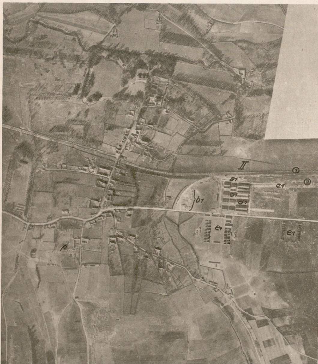
Fot. Nr. 168a Francuski obóz czołgów pod Erin (część zachodnia). Zdjęcia wykonano 10.III.18. Obóz znajduje się w pobliżu stacji węzłowej St. Pol. umożliwiającej przewóz czołgów w 4 kierunkach. Rozmiar obozu 500 X 700 m., nie licząc placu ćwiczeń. 1 — tory sortownicze (na 100 wag.), 2 — rampy załadunkowe z kranem. 3 — tor, prowadzący do warsztatów, 5 dużych namiotów (b), hala (ci) (g) i namioty (e) służą za schronienie czołgów. 4 namioty (d) i 3 namioty 7 — materiał. Skład i warsztaty i — podziemny skład benzyny. Pozatem około 120 czołgów na placu ćwiczebnym, 26 czołgów przy torach. K i l — baraki dla personelu. mogące pomieścić 250 ludzi. Skala 1:5000. zredukowano 1:3.
