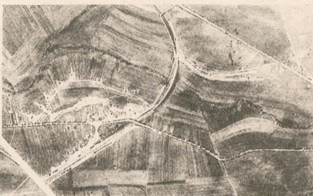
Fot. Nr. 239. Schrony w budowie pod Metz. Wys. 3500 m., F=26. Widać 7 wykopów i wyrzuconą ziemię oraz kolejkę wąskotorową.
