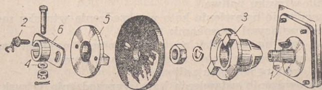
Rys. 4. Sprzęgło kłowe napędu pompy wtryskowej:
