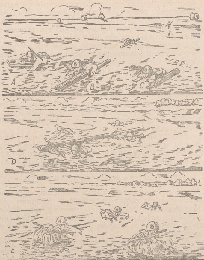
Rys. 305. Przeprowa wplaw na srodkach podręcznych przy wykorzystaniu: A — deski; B — okłagłaka; C — związanych kłocków; D — okragłaka dla przeprowy grupowej; E — plywaków z placht namiotowych
