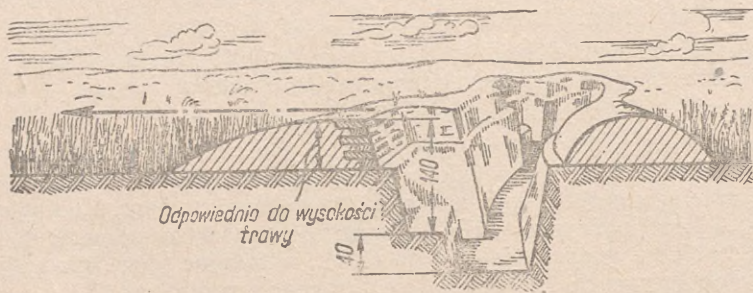
Rys. 185. Okop z podwyższonym przedpiersiem w terenie równinnym pokrytym wysoką trawą
