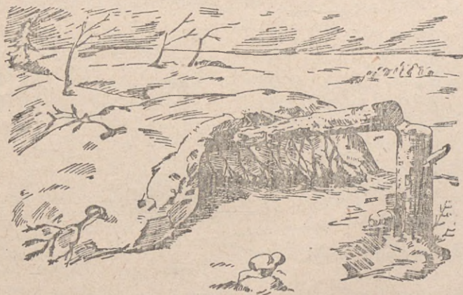
Rys. 364. Zasłona ze zrąbanego drzewa
