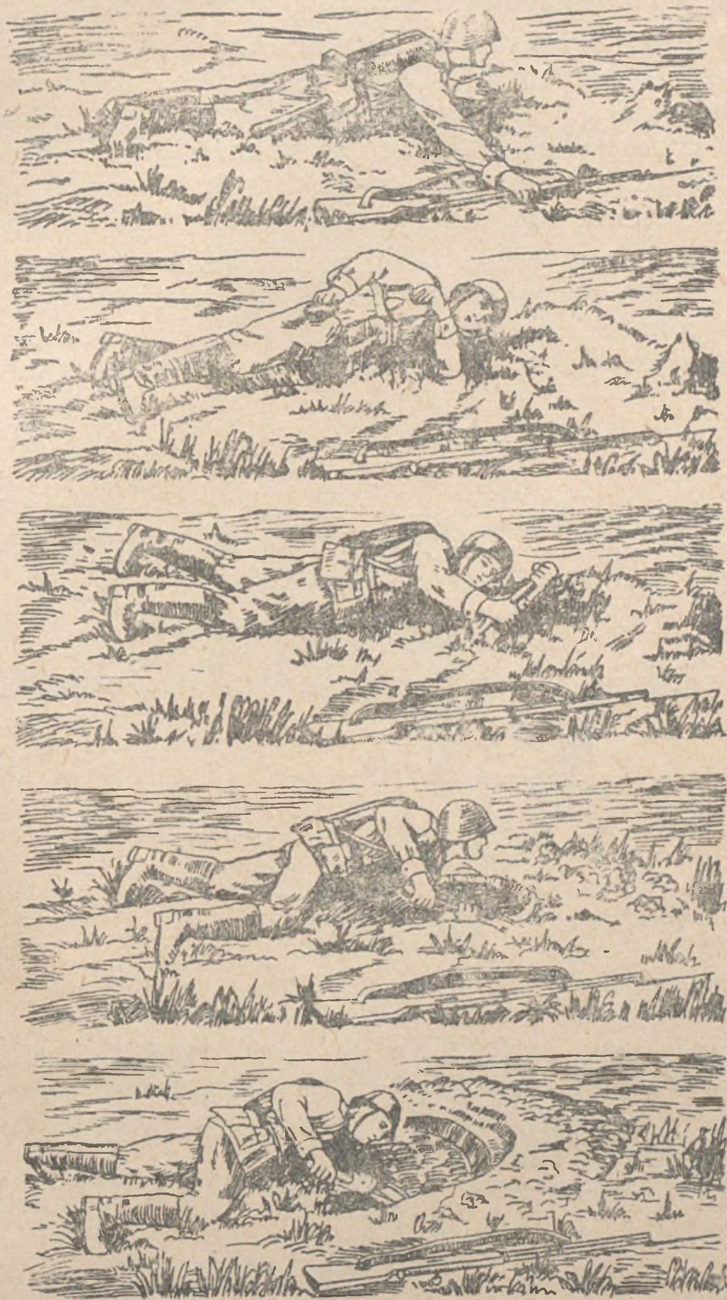
Rys. 49. Kopanie okopu pojedynczego dla leżącego pod ogniem nieprzyjaciela.
