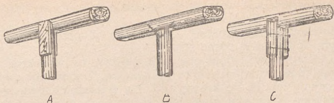
Rys. 347. Umocowywanie kaptura do pali w podporze ramowej:
