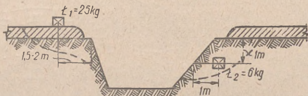
Rys. 259. Urządzenie jazdów w rowie przeciwczołgowym za pomocą ładunków MW
