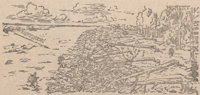
Rys. 253. Zasieka z drzew.
