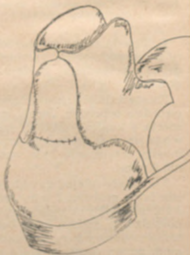
Rys. 47 — Cerowanie pękniętego zapiętki
