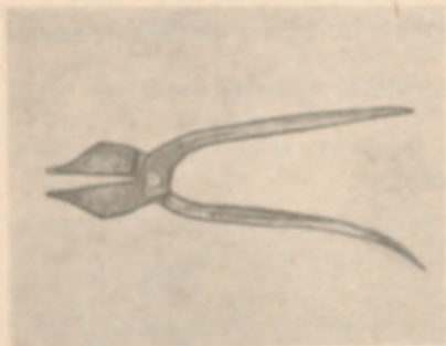
Rys. 14 — Szczypce (szewskie) o szczękach płaskich z nacięciami Rys. 15 — Hak do wyciągania kopyt
