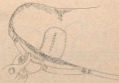
Rys. 50 — Łatka zaćwiekowana poprzednio zszyta i otwór zacerowany
