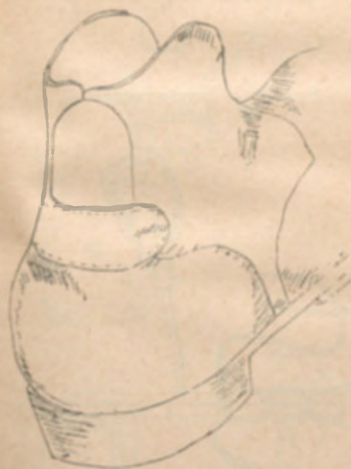
Rys. 48 — Łatka naszyta w miejscu pęknięcia
