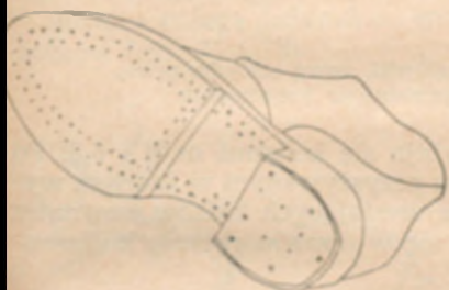
Rys. 65 — Wykończenie obcasa i przymocowanie zelówki
