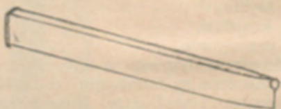
Rys. 20 — Przecinak z okrążkami
