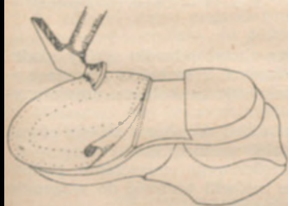
Rys. 71 — Przymocowanie zelówki gumowej z naklejonym papierem
