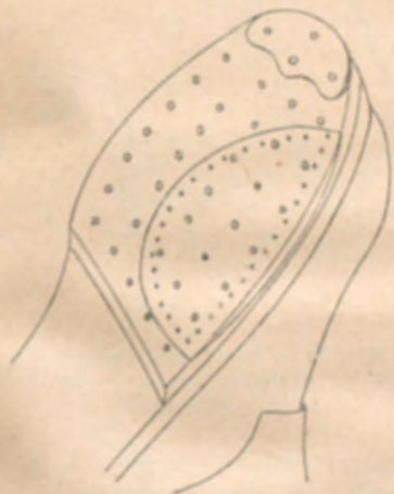
Rys. 34 — Częściowa naprawa zelówki trzewika
