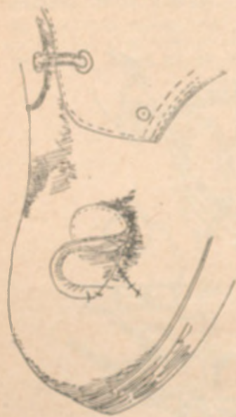
Rys. 59 — Naszywanie latki w części noska
