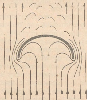
Rys. 57. Widmo opływu okrągłej czaszy spadochronu
