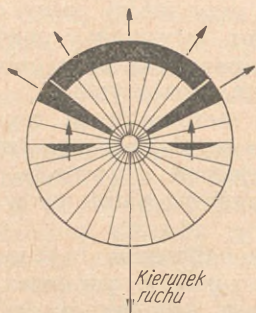
Rys. 137. Układ strug powietrza przy ruchu w przód spadochronu T-4 serii 4 M
