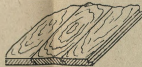
Łączenie na zakładkę
