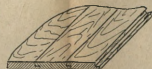
łączenie na zakładkę
