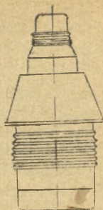
Rys. 26. Zapałnik M-1 a) Zapałnik z kapturkiem, b) zapałnik ze zdjętym kapturkiem uzbrojony
