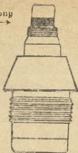
Rys. 33. Zapalnik M-1 uzbrojony „Na występującej części iglicy widoczny jest czerwony pasek — strzelać nie wolno“
