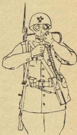
Rys. 3. Sprawdzenie szczelności maski właściwej.
