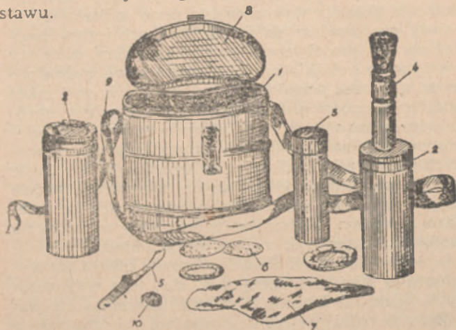
Rys. 20. Widok ogólny cekaemowo-moździerzowego zestawu odkażającego wz. PMDK:
