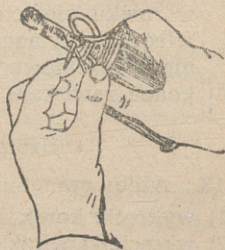
Rys. 5. Odgięcie końców zawlecзки
