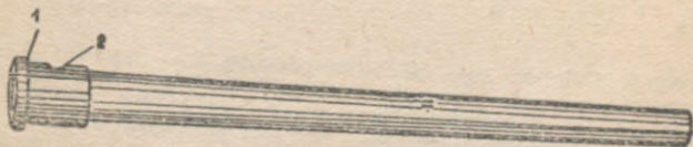
Rys. 4. Lufa: 1 — kołnierz, 2 -- wycięcie
