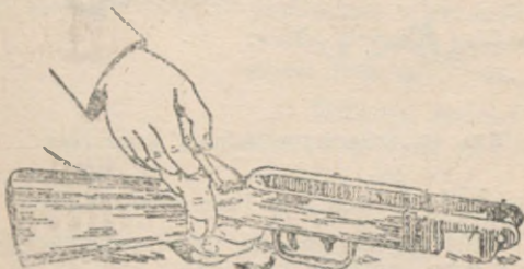
Rys. 42. Odkręcanie wkrętu głównego
