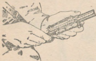
Rys. 69. Odłączenie od zamka sprężyny powrotnej z żerdzią i zderzakiem
