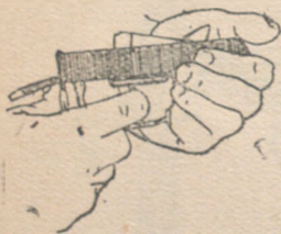
Rys. 45. Przesunięcie przełącznika na ogień pojedynczy
