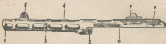
Rys. 5. Osłona: 1 — osłabiacz odrzutu, 2 — muszka, 3 — przednie ucho do pasa, 4 — osłona lufy, 5 — otwór do osi łączącej, 6 — pokrywa komory zamkowej, 7 — celownik (przerzutowy), 8 — zatrzask pokrywy
