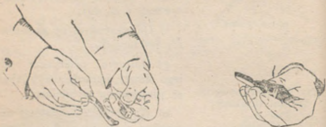
Rys. 50. Wkładanie przerywacza do obsady
