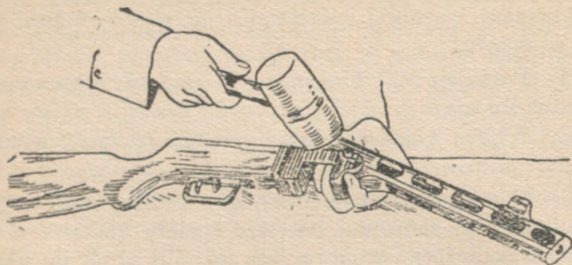
Rys. 52. Wkładanie osi łączącej
