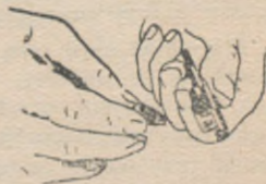
Rys. 49. Odłączanie sworznia przełącznika od obsady przerywacza
