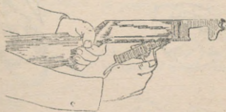
Rys. 43. Odłączanie komory spustowej
