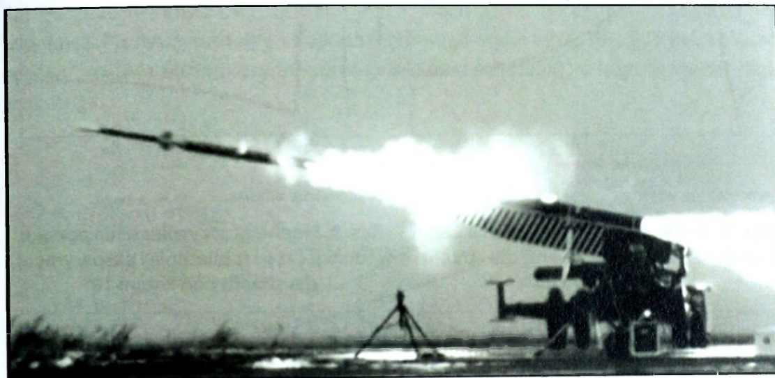
Fot. 8. Moment startu pocisku raketowego z wyrzutni ustawionej pod kątem 10^\circ
