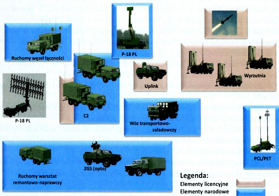
Rys. 3. Elementy zestawu objęte umową licencyjną – kolor różowy
