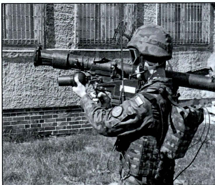
Fot. 5. Widok głowicy optoelektronicznej w WD-95 z widoczną anteną IKZ
