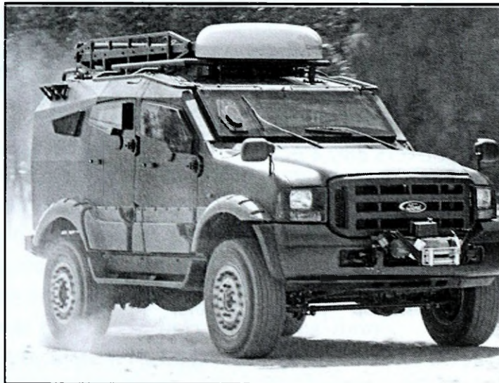
Fot. 3. Antena satelitarna SOTM
