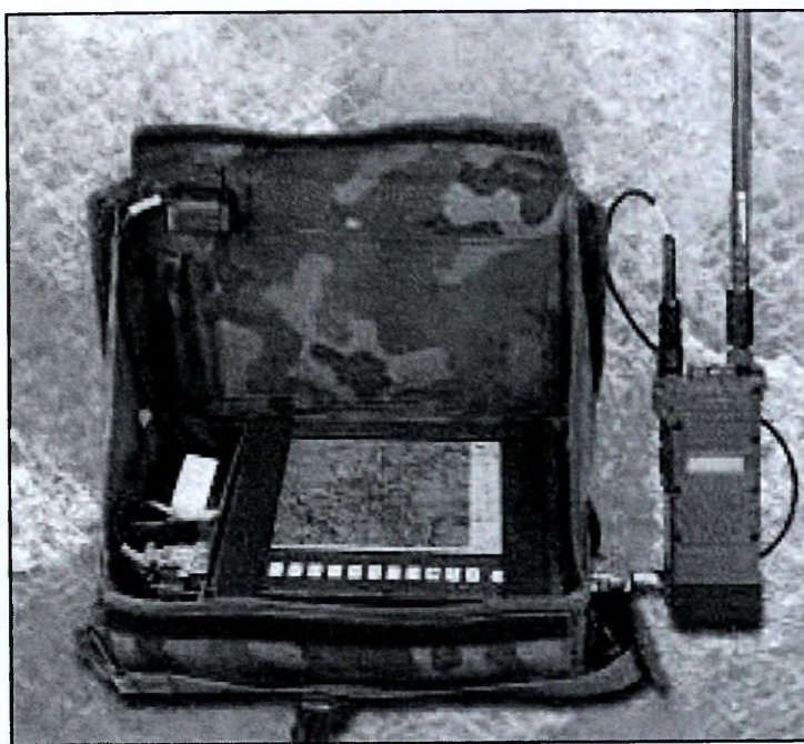
Fot. 3. Terminal REGA-4 dowódcy przenośnych przeciwlotniczych zestawów raketowych GROM
