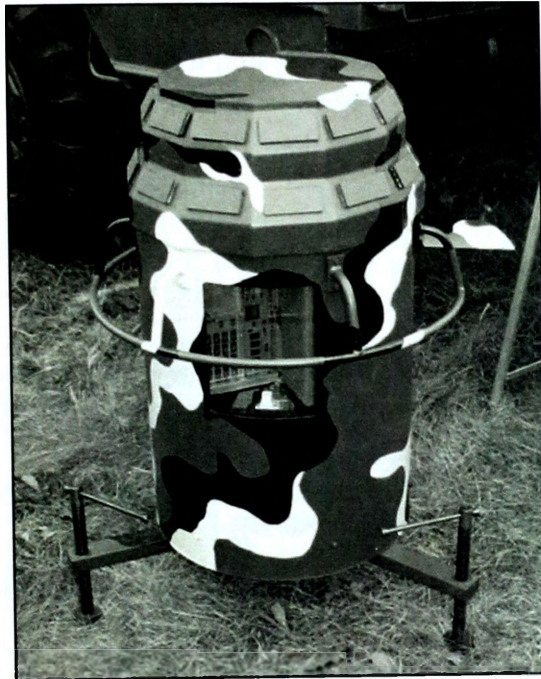
Fot. 3. Przenośna pułapka radiolokacyjna imitująca PRWB OSA
