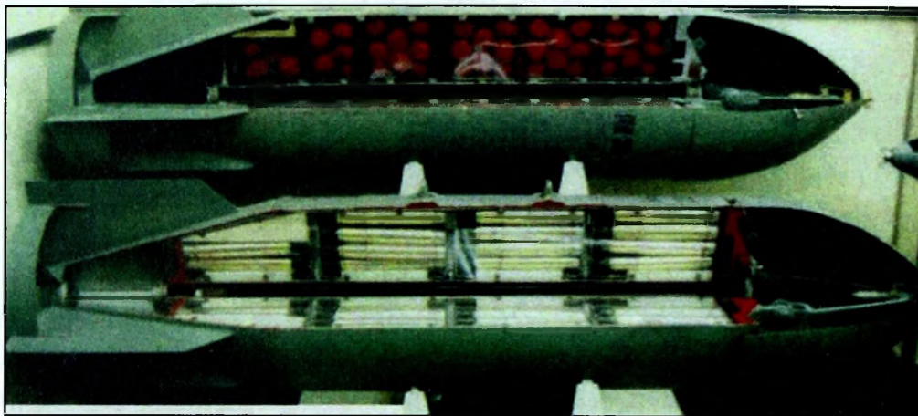
Fot. 8. Przekroje kaset bombowych RBK-500 BETAB (w głębi) i RBK-500AO-2,5 RT 8
