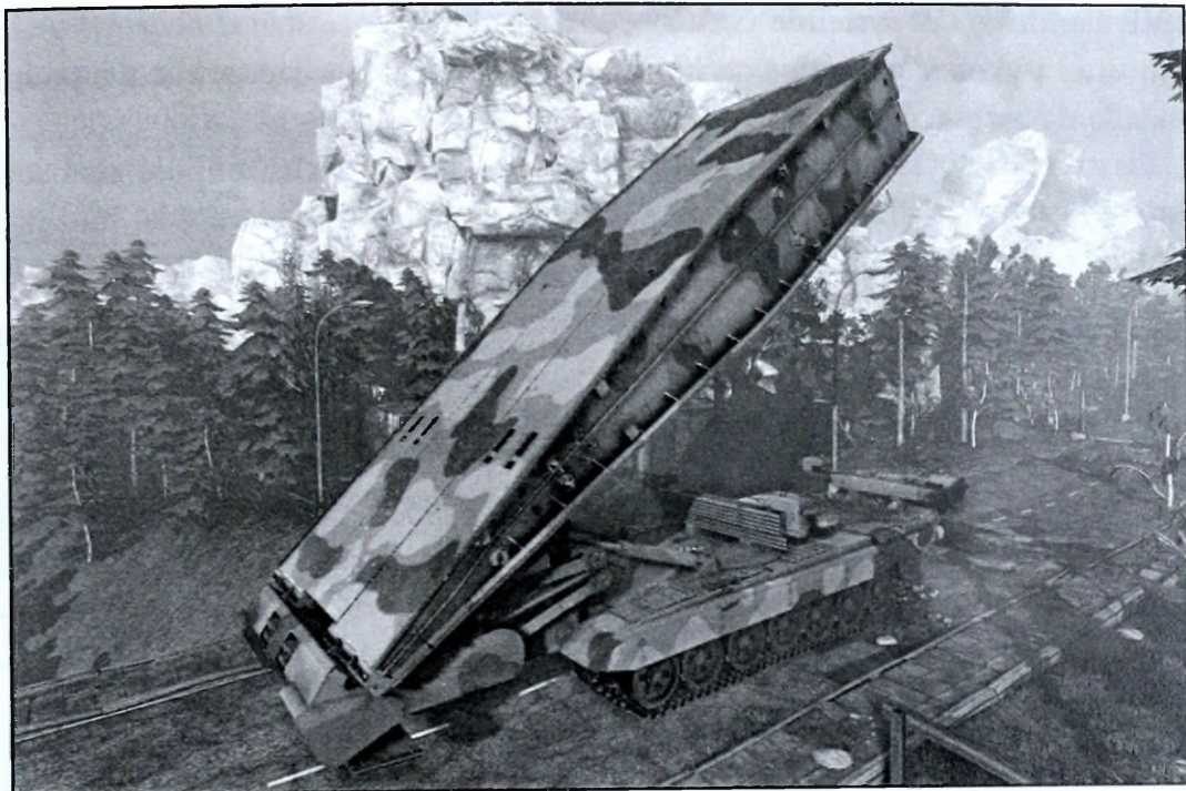
Fot. 5. Przykład zobrazowania symulatora proceduralnego dla mostu MG-20
