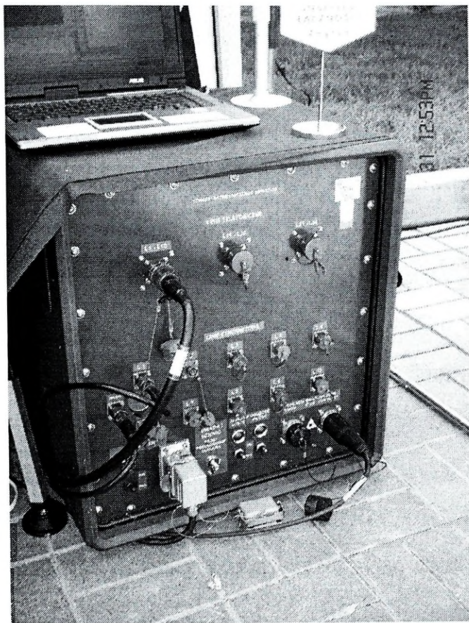
Zdjęcie 1.6. Koncentrator LANTELBOX będący rozwinięciem o część telefoniczną koncentratora LANBOX LB10K-PKS.
