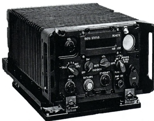
Zdjęcie 1.1. Widok ogólny brytyjskiej radiostacji HCDR.
