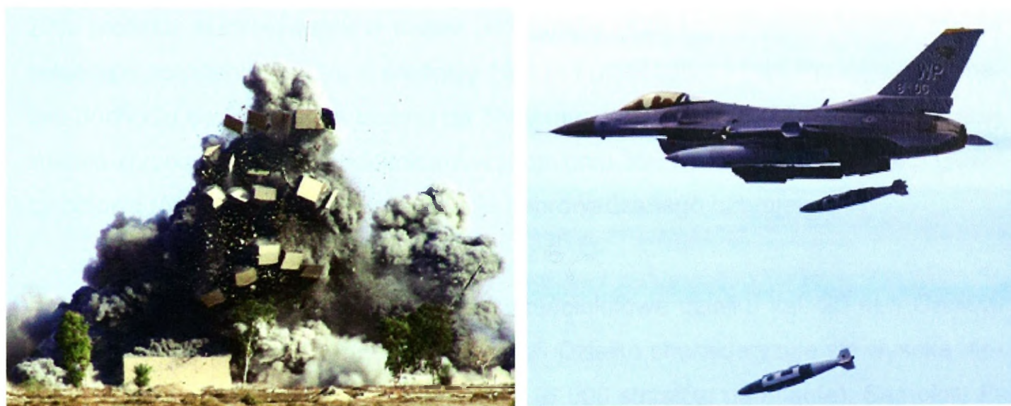
Rys. 51. Zrzut bomb JDAM przez F-16 oraz efekt uderzenia jednego obiektu dwoma bombami uderzającymi bezpośrednio jedna za drugą
