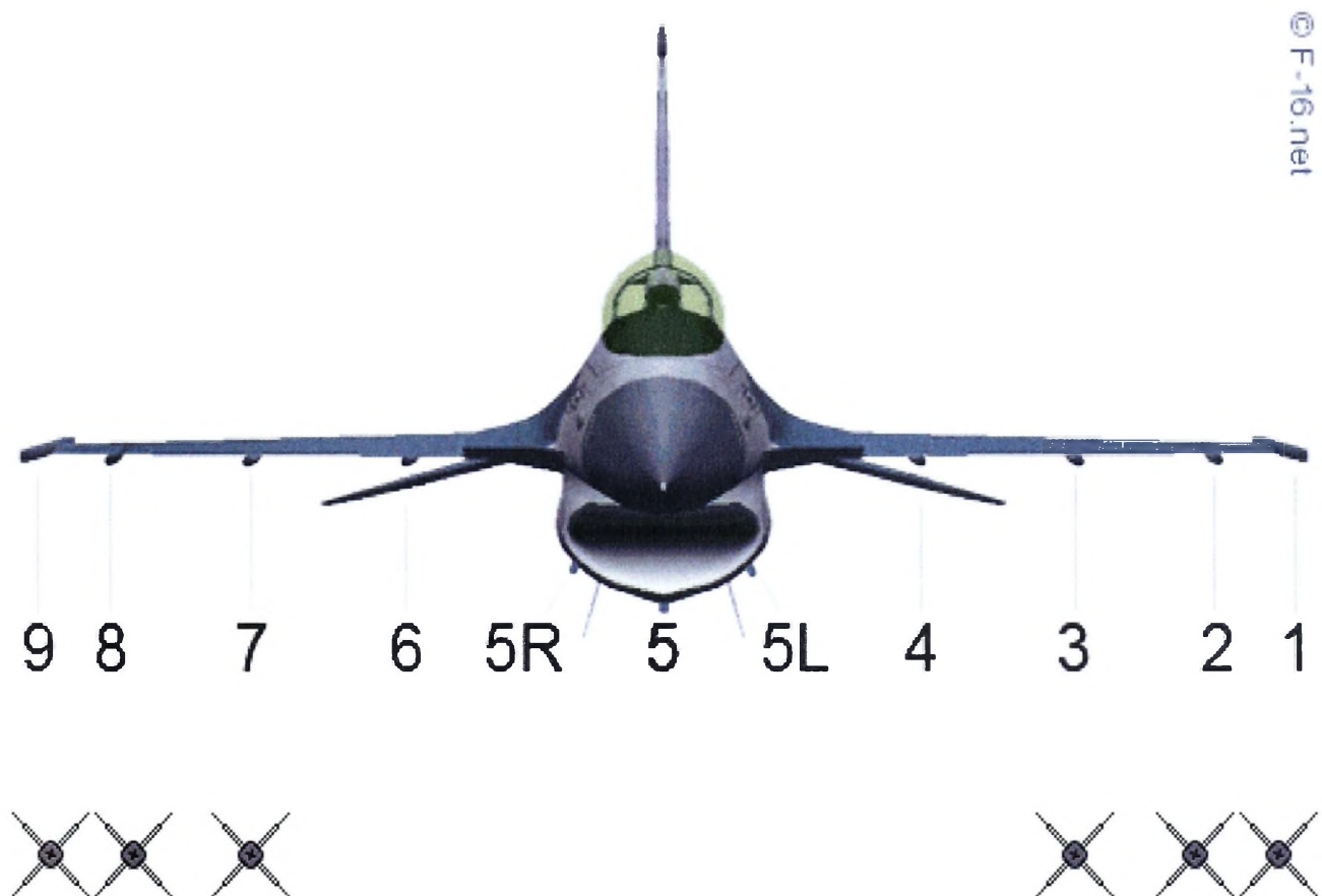
Rys. 23. Możliwości podwieszania pocisków AIM-120C AMRAAM na samolocie F-16 C/D Block 52+
