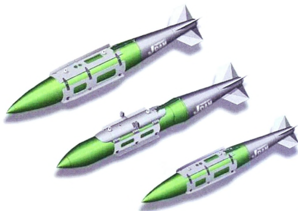
Rys. 49. Pakiety JDAM z bombami MK 84, BLU-109/B, MK 83 Źródło: http://www.designation-systems.net/dusrm/app5/jdam.html
