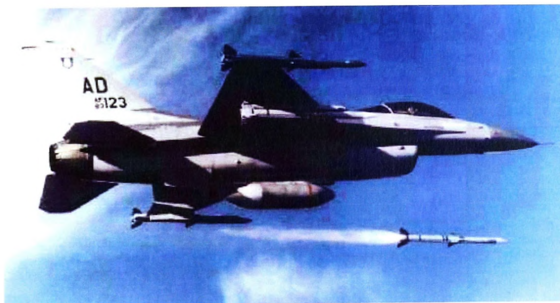
Rys. 27. Odpalenie pocisku AIM-120C AMRAAM z samolotu F-16
