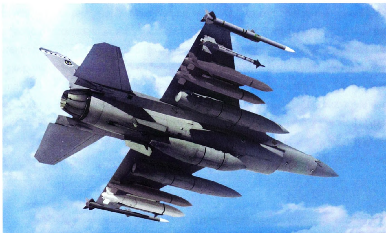
Rys. 47. AGM-154C na podwieszeniach samolotu F-16 Źródło: Materiały informacyjne Lockheed Martin
