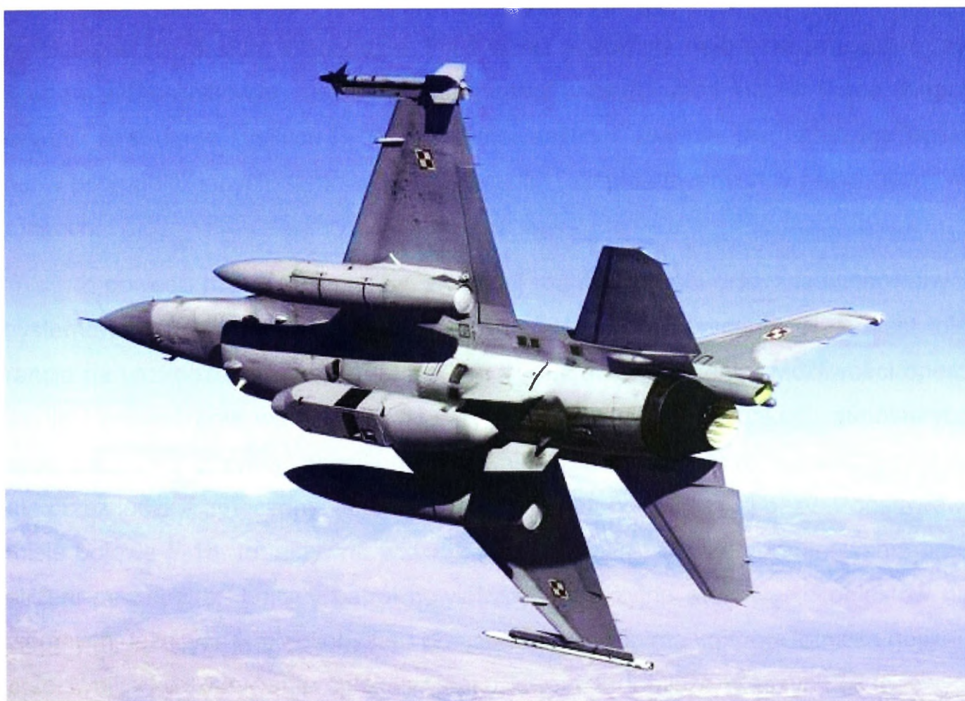
Rys. 2. F-16C block 52 z zasobnikiem Goodrich DB-110 EO/IR Źródło: http://www.f-16.net/gallery_item205672.html [Photo by Tom Reynolds]
