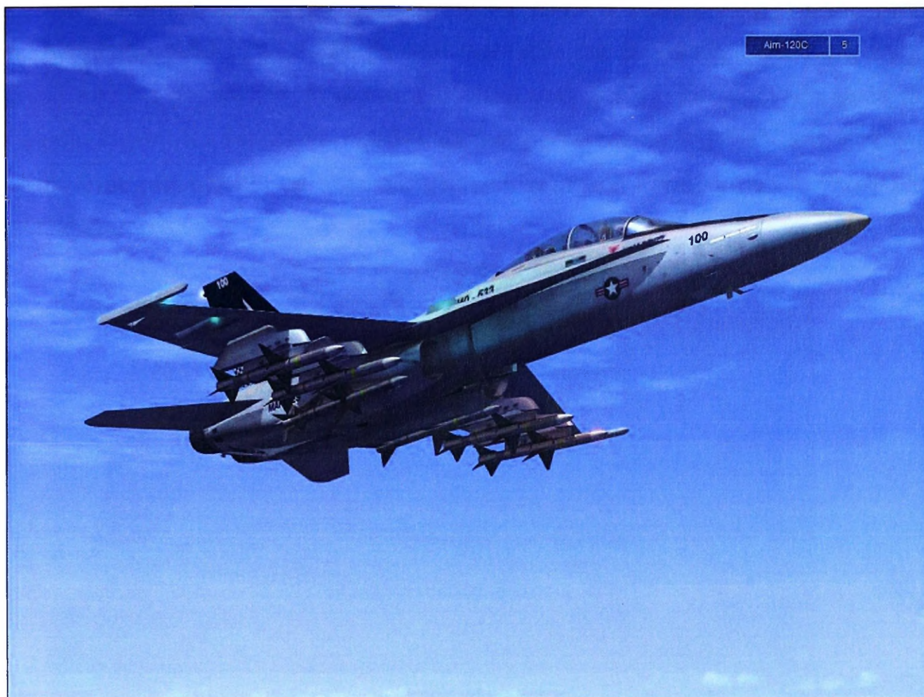
Rys. 26. Pociski AIM–120C AMRAAM na podwieszeniach samolotu F-18
