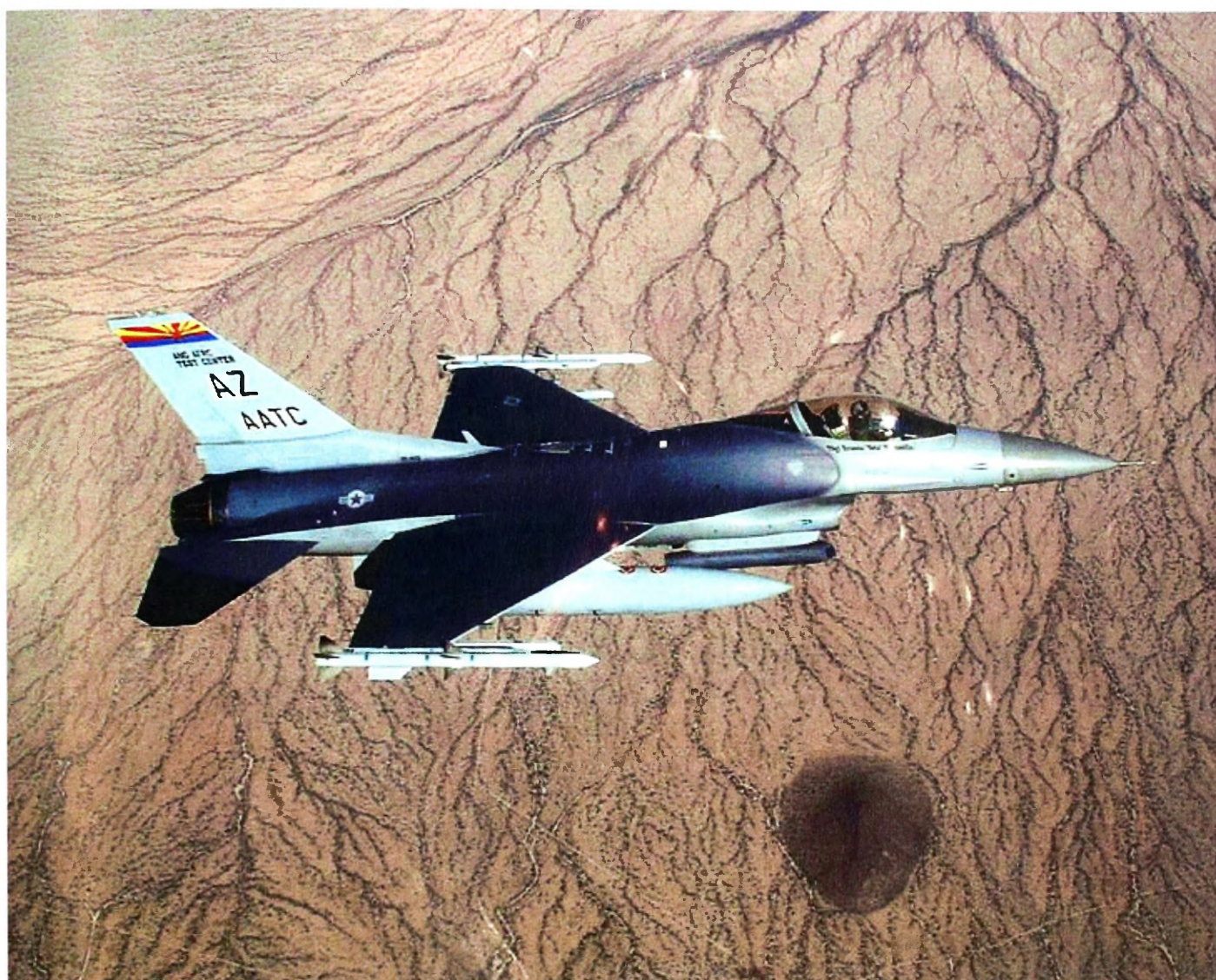
Rys. 33. Samolot F-16 z podwieszonym zasobnikiem PANTERA
