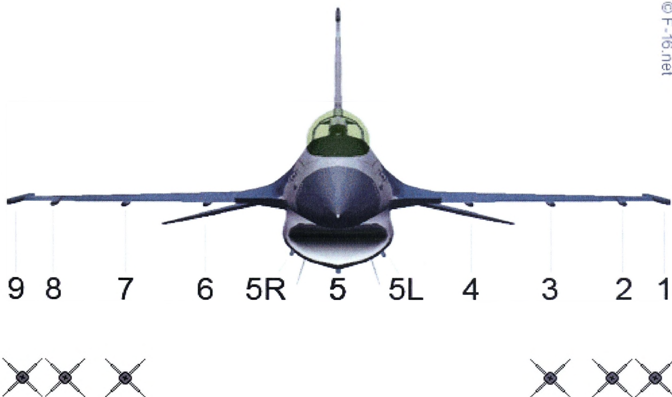
Rys. 21. Możliwości podwieszania AIM-9X na samolocie F-16. Źródło: http://www.f-16.net/f-16_armament_article1.html
