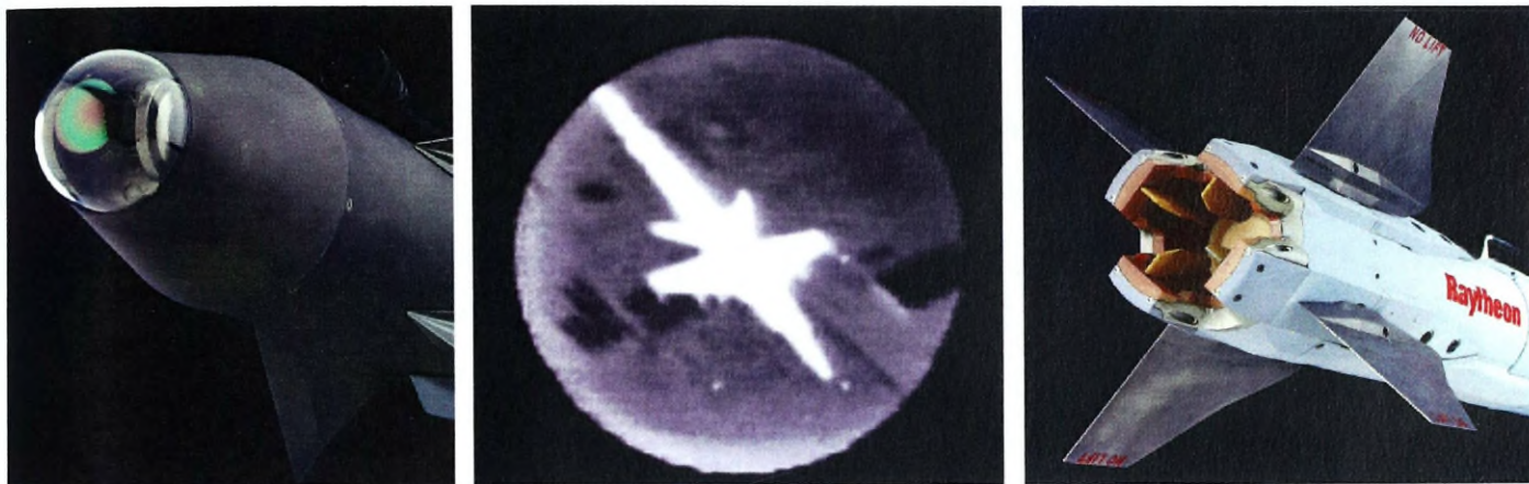
Rys. 19. Samonaprowadzająca się głowica, obraz obserwowanego przez głowicę obiektu oraz układ gazodynamicznego sterowania
