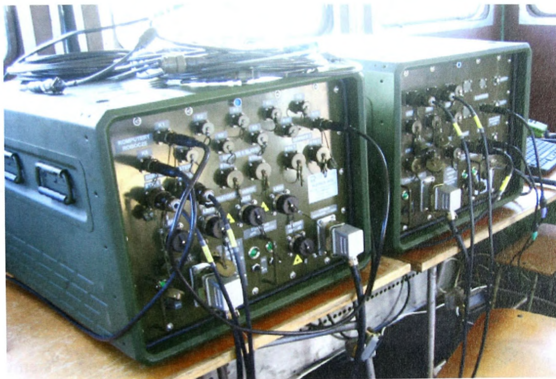
Rys. 4.15. Widok systemu SERWER BOX-2 (wersja rozbudowana w dwu pojemnikach) Źródło: Zdjęcie własne wykonane na ćwiczeniu „Pierścień 2005”.
