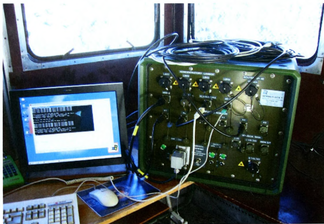
Rys. 4.14. Widok systemu SERWER BOX WP (wersja podstawowa z klawiaturą i monitorem RMK-1)
