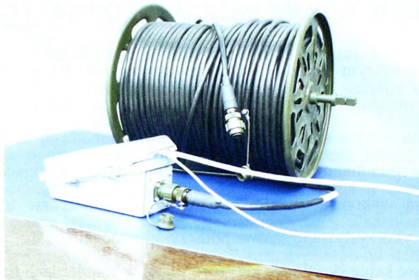
Rysunek 4.1. Polowy kabel skrętkowy PKS 2x2x0.34 na bębnie PKL
