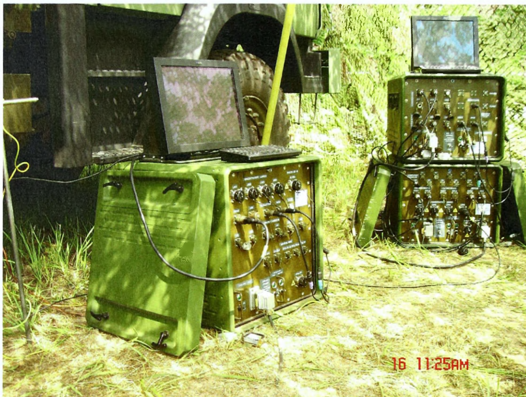
Zdjęcie 3.7. Rozwinięte w polu dwa systemy SERWER BOX na SD (z lewej system wersji podstawowej, z prawej w wersji rozbudowanej)
