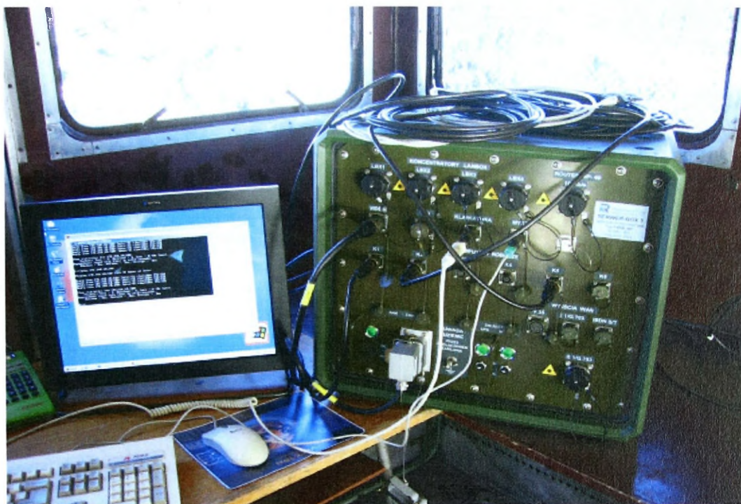
Zdjęcie 3.8. Widok systemu SERWER BOX WP (wersja podstawowa z klawiaturą i monitorem RMK-1)
