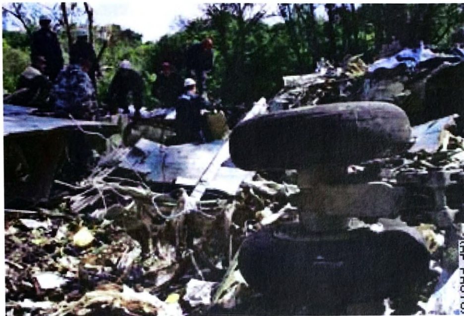
Rys. 16. Szczątki rozbitego po wybuchu ładunku bombowego w powietrzu samolotu Tu-134 lot nr 1303 linii lotniczych Volga-Aviaexpress
