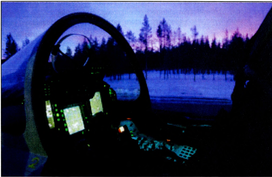
Fot. 8. Wskaźniki parametrów lotu i sytuacji taktycznej HUD i HDD samolotu wielozadaniowego Eurofighter Typhoon
