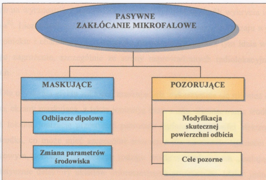
Rys. 2.1.7. Rodzaje mikrofalowego zakłócania pasywnego
