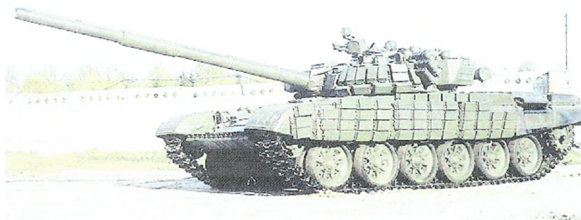
Rys. 4.4. Rosyjski Czołg T 72 z aktywnym pancerzem
