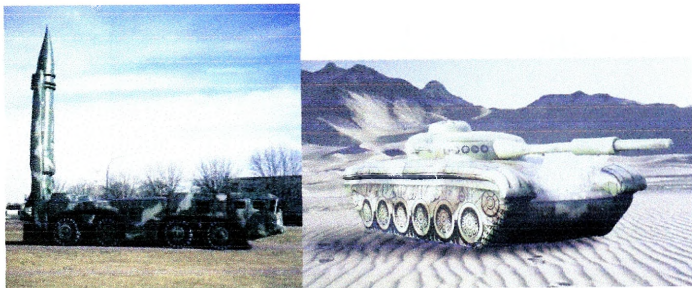
Makiety pneumatyczne wyrzutni rakiet SCUD i czołgu T-72 stosowane przez wojska irackie w operacji „Pustynna Burza” w 1991 roku
