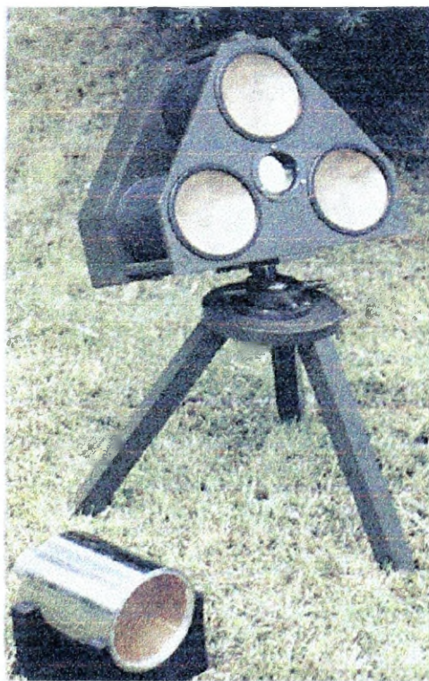
Polska mina przeciwlotnicza składająca się z zespołów ładunków formowanych 311 (z ang. Explosively Formed Projectile-EFP)
