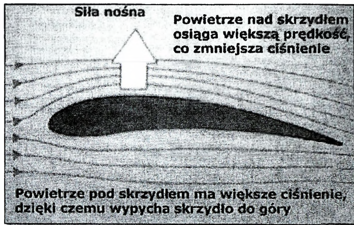
Rys. 3.40. Zasada powstawania siły nośnej na profilu aerodynamicznym
