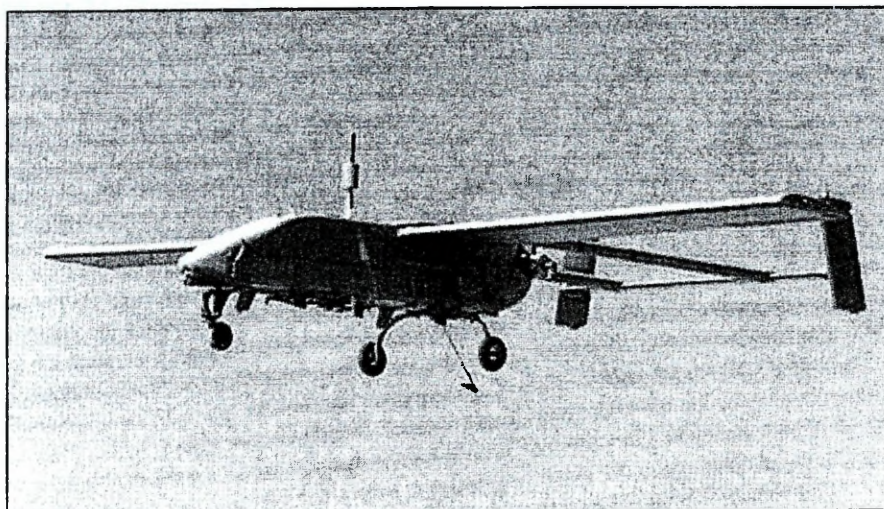
Rys. 6.6. Pioneer podczas podejścia do lądowania na pokładzie okrętu wysuniętych hakiem do wyhamowania
