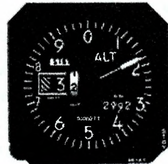
Rys. 9.8. Wskaźniki i zasada działania wysokościomierza barometrycznego
