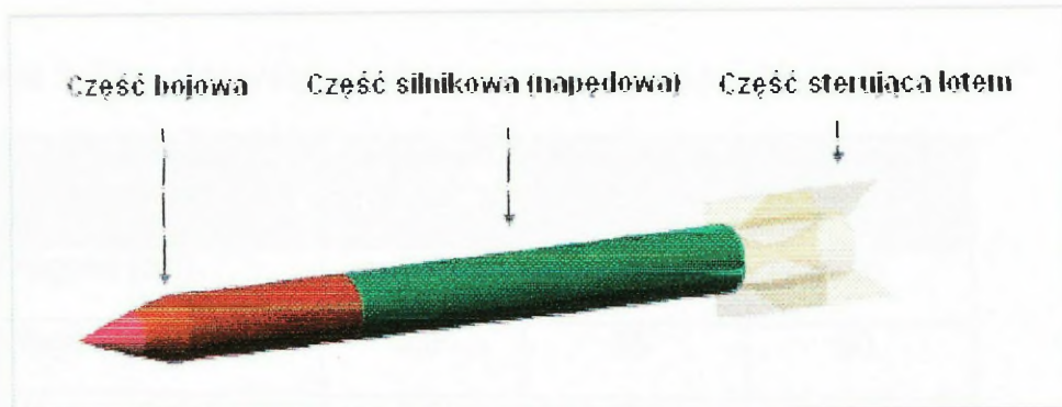
Rys. 3. Zasadnicze części rakiety „Kassam” 22
