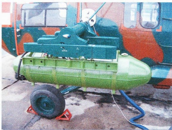
Zdj. 2.5. Zasobnik z urządzeniem dymotwórczym na podwieszeniu zewnętrznym śmigłowca W-3W „Sokół”
