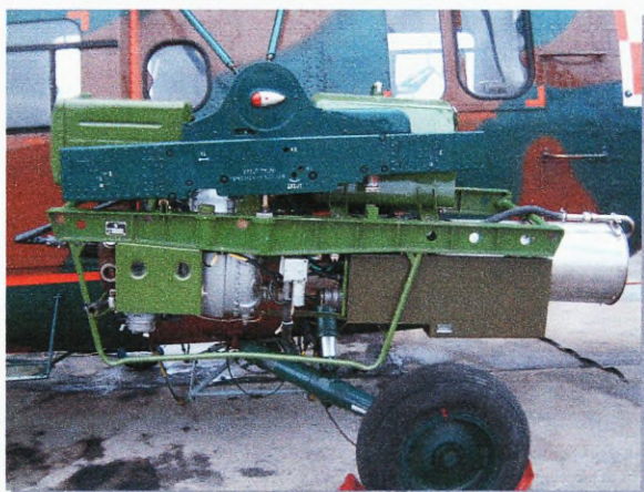
Zdj. 2.6. Zasobnik ze zbiornikiem cieczy dymotwórczej na podwieszeniu zewnętrznym śmigłowca W-3W „Sokół”
