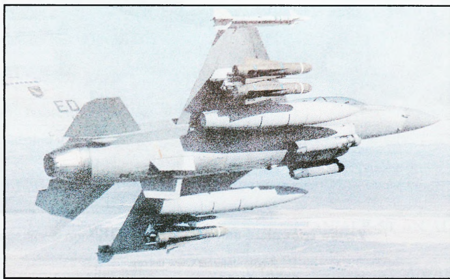
F-16C USAF uzbrojony w pociski „powietrze-ziemia” AGM-65, widoczne również zasobniki systemu LANTIRN
