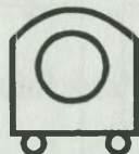
Rysunek 19 Środek radiowy (radiostacja) zamontowany na nieopancerzonym pojeździe kołowym
