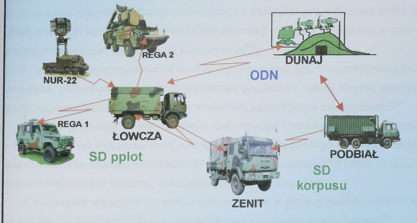
Rys.32. Schemat ideowy pozyskiwania informacji o sytuacji powietrznej na potrzeby OPTKWL w operacji obronnej
