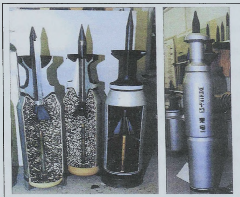
Zdjęcie 4. Naboje APFSDS do 120 mm armaty, po prawej perspektywiczny 140 mm pocisk podkalibrowy (Fot. A. Kiński)
