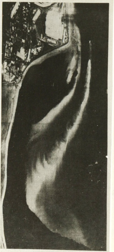
Rys. 28. Termogram obszaru nadmorskiego. Prąd ciepły wychodzi w postaci jasnych smug.
